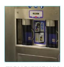
可使用高容量双瓶模块固定在技术 间进行房间的净化
